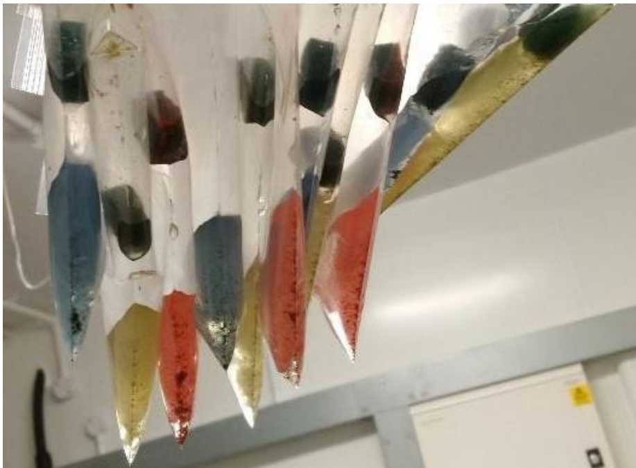
Abbildung 4: Zip-Lock-Beutel und Scheuerschwämme nach dem Ausdrücken der während des Scheuertests absorbierten Beschichtungen.
