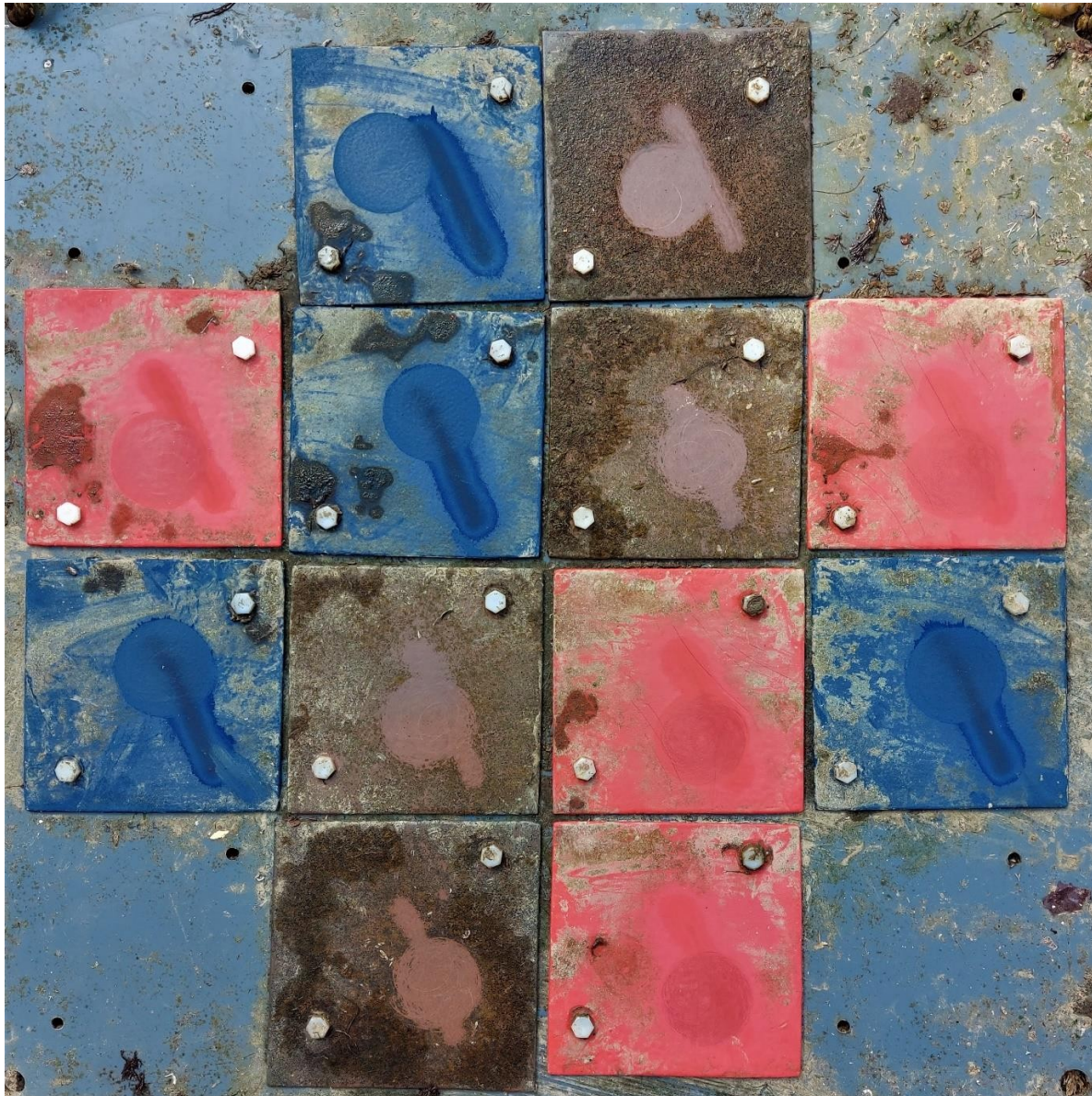
Abbildung 9: Repräsentatives Bild einer Trägerplatte und von Platten nach standardisiertem Scheuern, Hochdruckreinigung und Wiederausammenbau nach dem Test. Blaue Platten stehen für Cruiser 250, braune/kupferfarbene Platten für Coppercoat und rote Platten für Micron 350. Beachten Sie die kreisförmigen Scheuerspuren und die linearen Hochdruckreinigungsspuren. Beachten Sie auch, dass die Behandlungen in allen Fällen stark genug waren, um alle Verschmutzungen aus den behandelten Bereichen zu entfernen.
