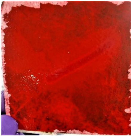
Abbildung 5: Spur der Hochdruckreinigung auf einer mit Micron 350 beschichteten Testplatte. Der Kontrast des Bildes wurde zur besseren Übersichtlichkeit verstärkt.
