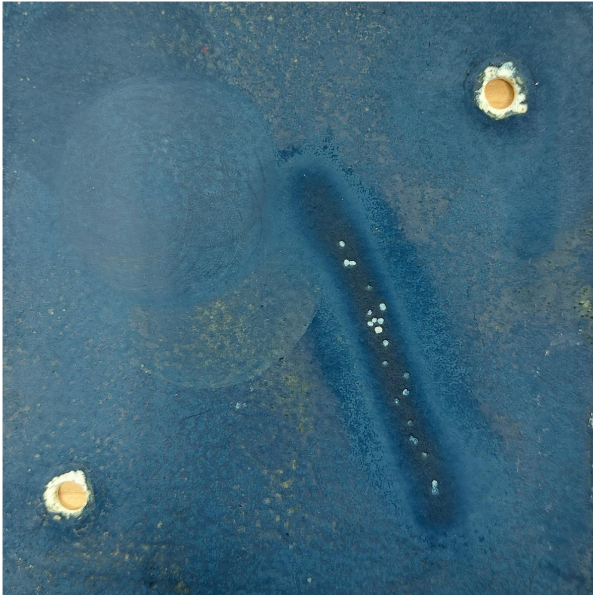
Abbildung 16: Repräsentatives Nahbild einer Cruiser 250-Platte nach drei simulierten Reinigungsvorgängen (Scheuern und Hochdruckreinigung), abschließender Reinigung von Biofouling und Trocknung. Beachten Sie die runde Markierung des standardisierten Schrubbens oben links auf der Platte und die lineare Markierung des standardisierten Hochdruckreinigens in der Mitte bis unten rechts auf der Platte. Beachten Sie auch, dass diese Beschichtung durch die Hochdruckreinigung so weit entfernt wurde, dass das Substrat nach dem dritten Hochdruckreinigungszyklus sichtbar wurde (weiße Flecken im Bereich der Hochdruckreinigung).
